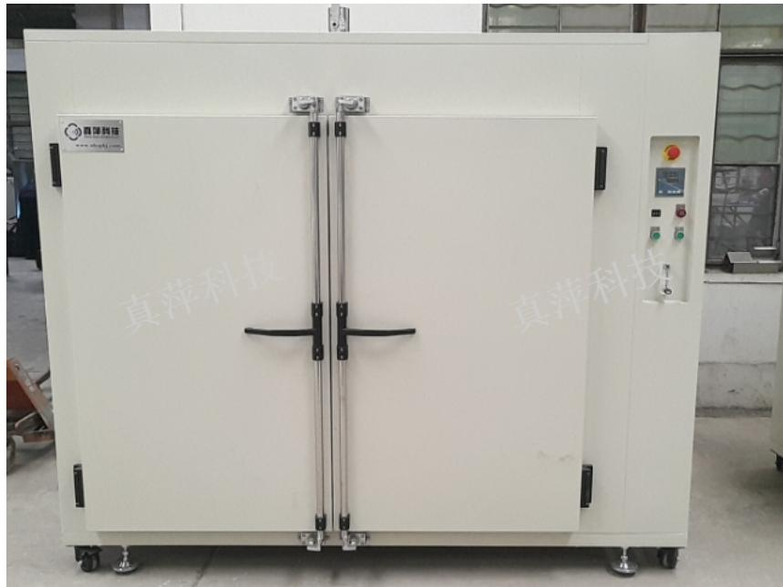
一、产品材质1. 外箱采用1.5mm厚Q235冷轧钢板/内箱采用1.5mm厚SUS304#不锈钢；2. 保护装置定时报警断电装置、超温断电、漏电保护断路器、电机过载保护。二、产品特点1. 双边配有链条传动，解决传送过程中跑偏的现象；2. 烘箱分段式加热，单独电箱控制，方便操作，结构主要由输送机系统与烘干炉两大部分组成，多段单独PID温度控制，炉内温度均匀；4. 输送速度变频调速，调节自如，运行平稳，产能高；5. 每段单独箱体设置废气排放接口，可外接到车间外面，避免车间废气污染。
